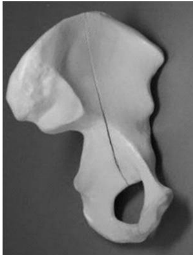
Abbildung 5: Frakturverlauf der hohen vorderen Pfeilerfraktur im Beckenmodell
