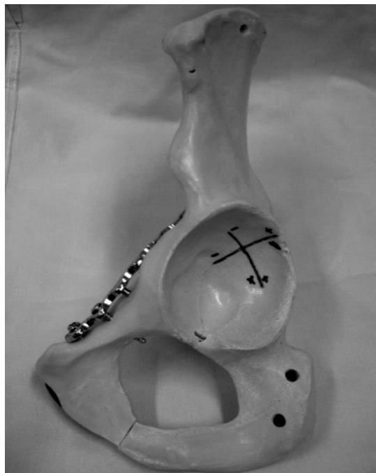
Abbildung 10: Koordinatensystem für die Messung der Frakturdislokation im lasttragenden Bereich, der Messpunkt entspricht dem Ursprung des Koordinatensystems.
