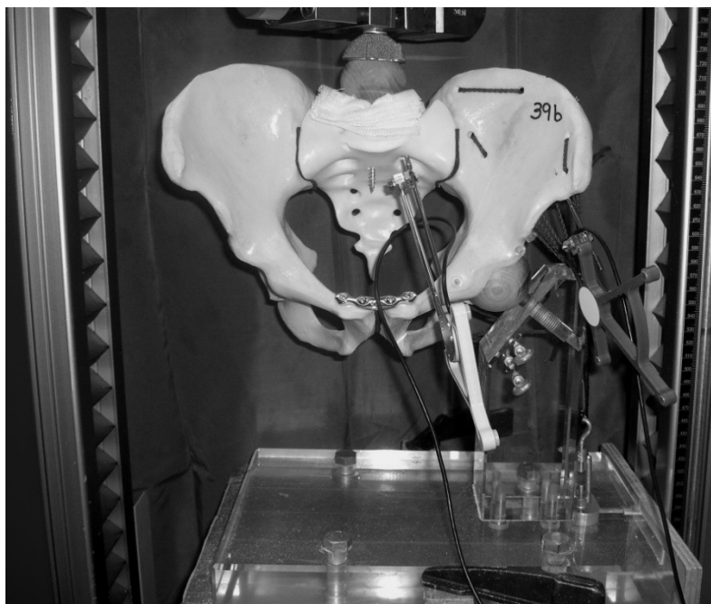
Abbildung 9: Versuchsaufbau der Einbeinstand-Simulation am Beckenmodell
